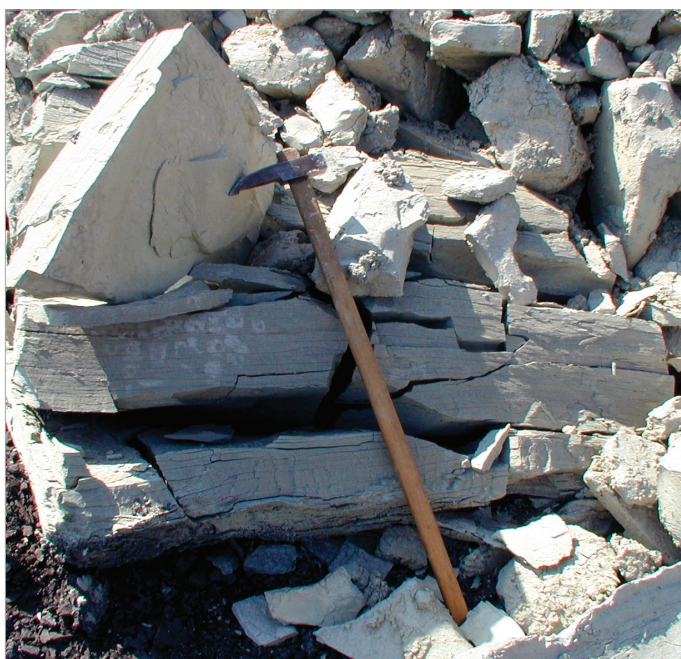
Obr. 3 a 4: Makroskopické vlastnosti jílu šedých (výsypka Merkur) a jílu cyprisové série (výsypka Boden) listkovitě zpevněných.
