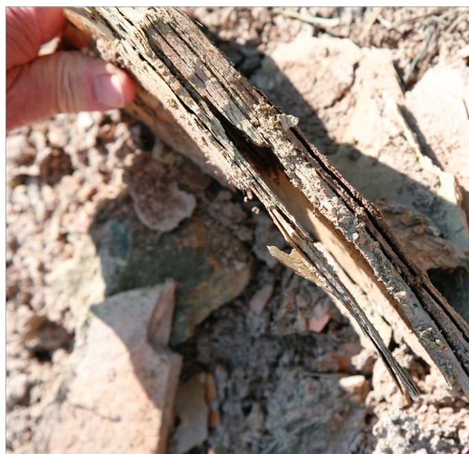
Obr. 3 a 4: Makroskopické vlastnosti jílu šedých (výsypka Merkur) a jílu cyprisové série (výsypka Boden) listkovitě zpevněných.
