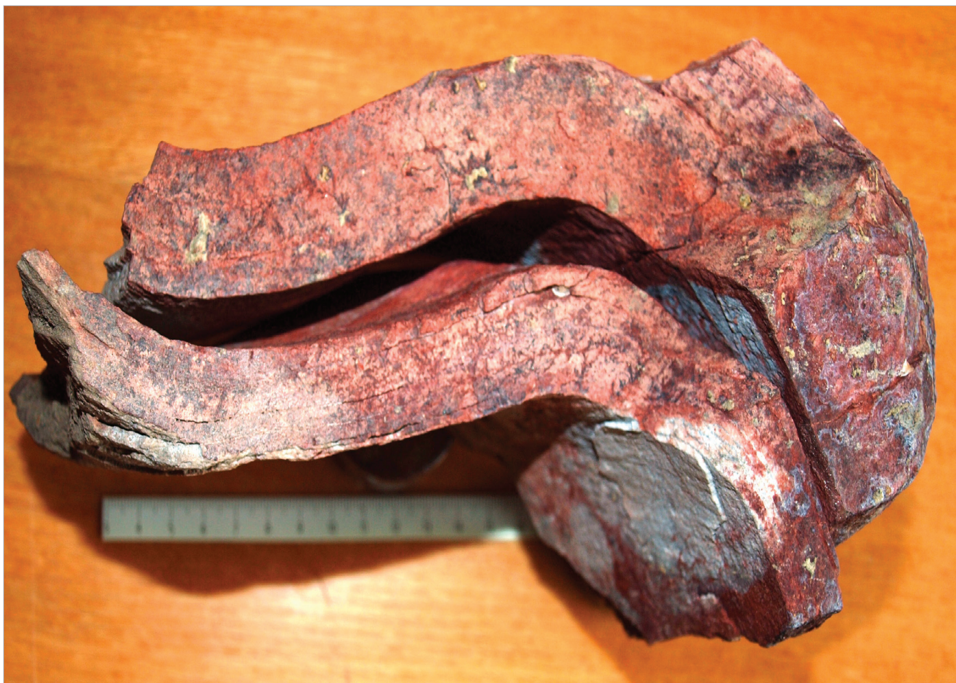
Obr. 10: Xenolit zvrásněného, fritovaného kvarcitu, uvolněný ze strusky, ŽH - V část, sekvence C.
