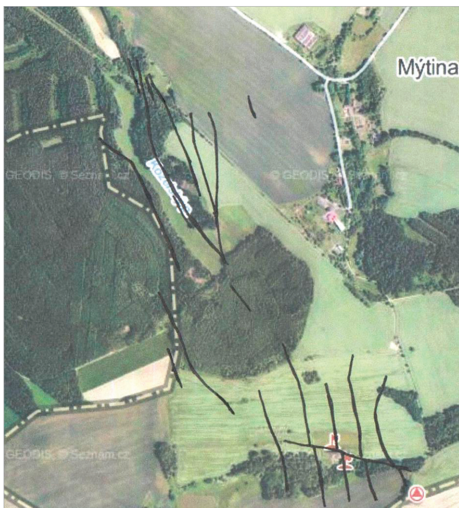
Obr. 3: Tektonická skica okolí Železné hůrky a zalesněného kruhového maaru JZ od Mýtiny. Průměty zlomů jsou vyznačeny černými liniemi.
