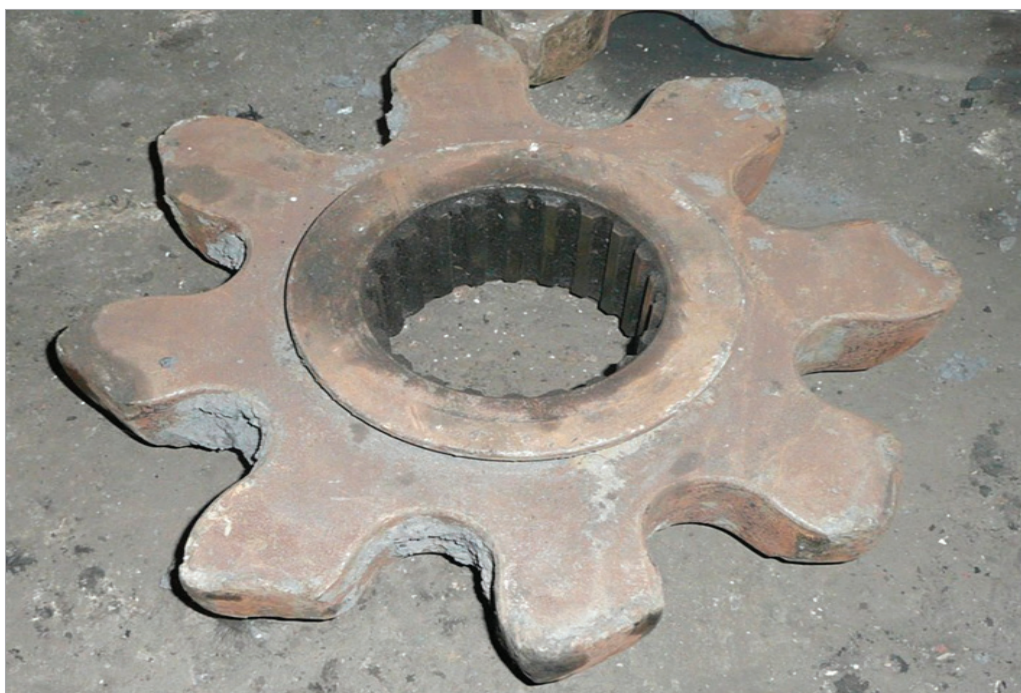
Obr. 4: Cékové kolo – opotřebení na hlavě zubu.
