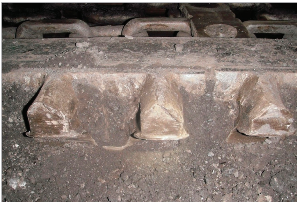
Obr. 3: Opotřebení hřebenu pojezdové tratě.
