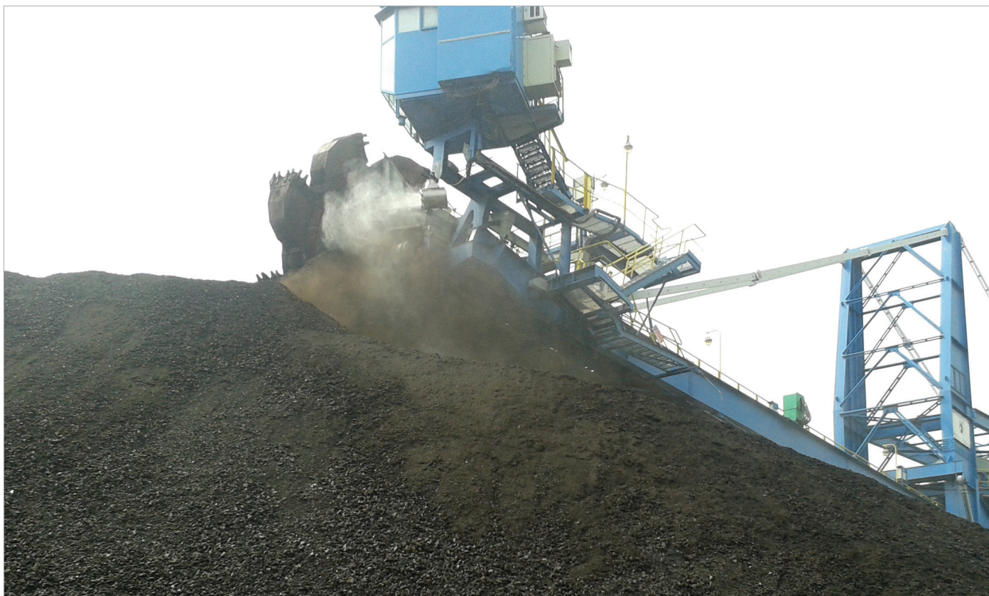
Obr. 4: Nasazení rotačního atomizéru na USSK3 Vršanské uhelné a.s.
