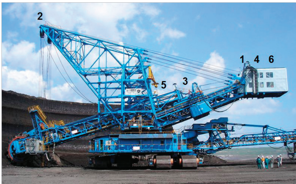
Obr. 1: Rozmístění přijímačů GNSS a přijímačů na rýpadle K 800/N1/103.
