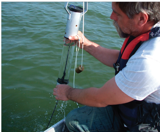
Obr. 2: Odběr vzorků vody hlubinným odběrákem (vlevo) a měření průhlednosti vody Secchiho deskou (vpravo).
