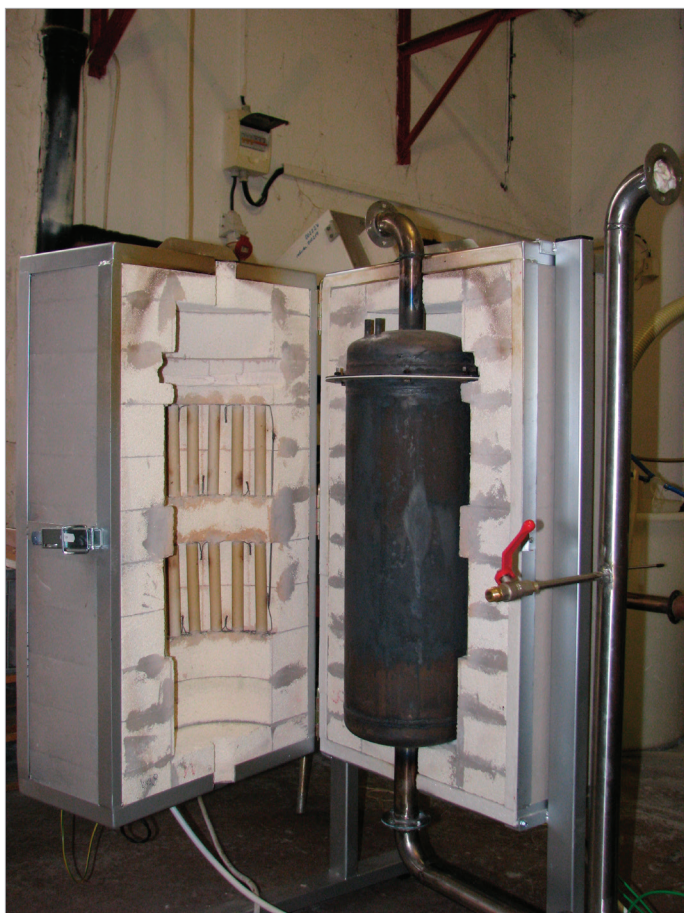
Obr. 2: Termicko-katalytický reaktor a dvoupásmové elektrické topné pece.
