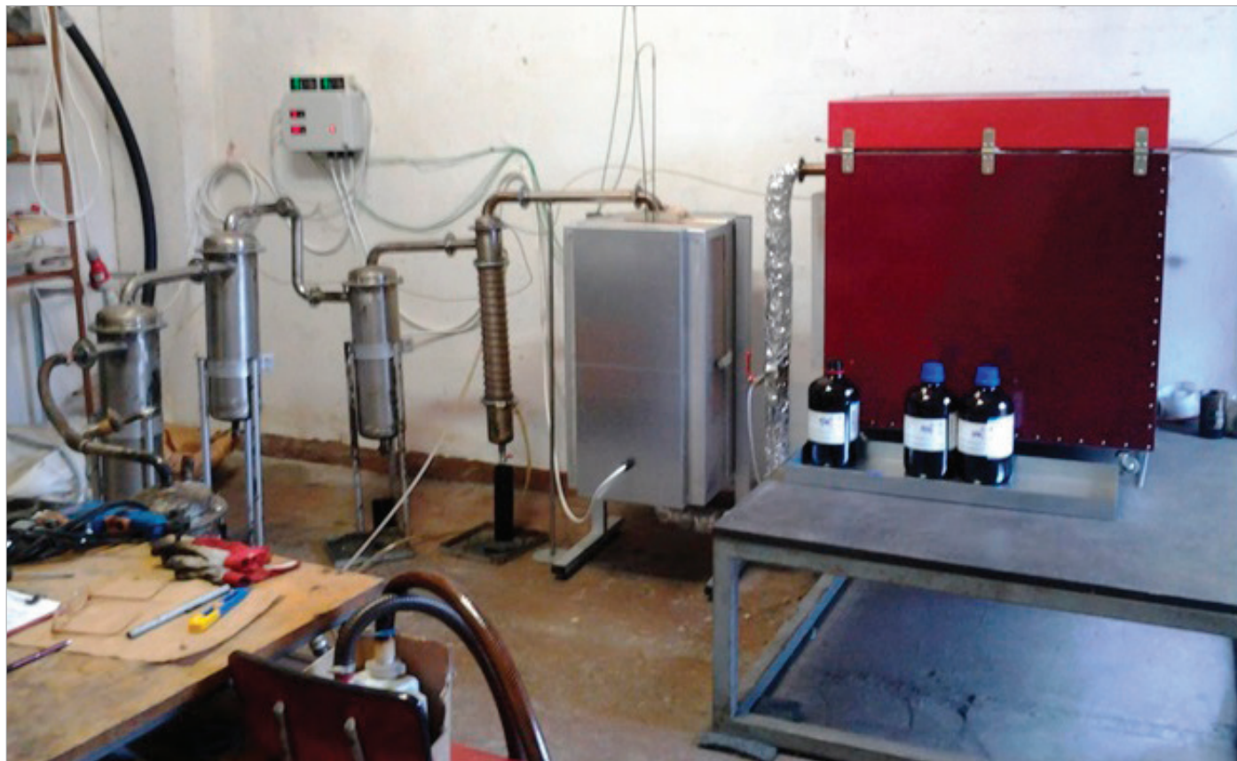
Obr. 3: Zapojení termicko-katalytického reaktoru do pyrolýzní jednotky.
