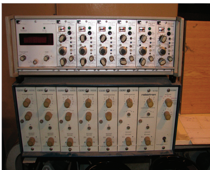
Obr. 7: Měřicí ústředny pro přenos signálů snímačů síly.
