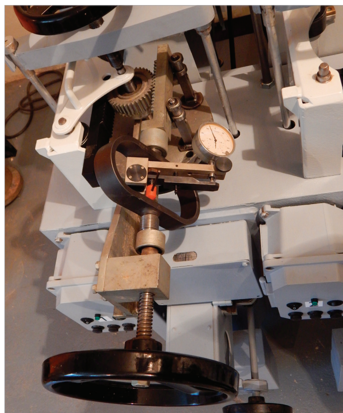
Obr. 13: Kalibrační přípravek se siloměrným třmenem.
