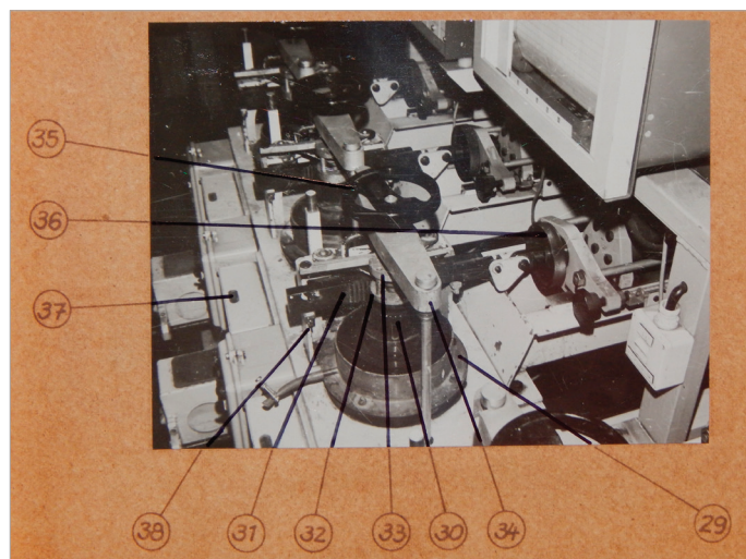
Obr. 3: Detail původní konfigurace torzního smykového přístroje.
