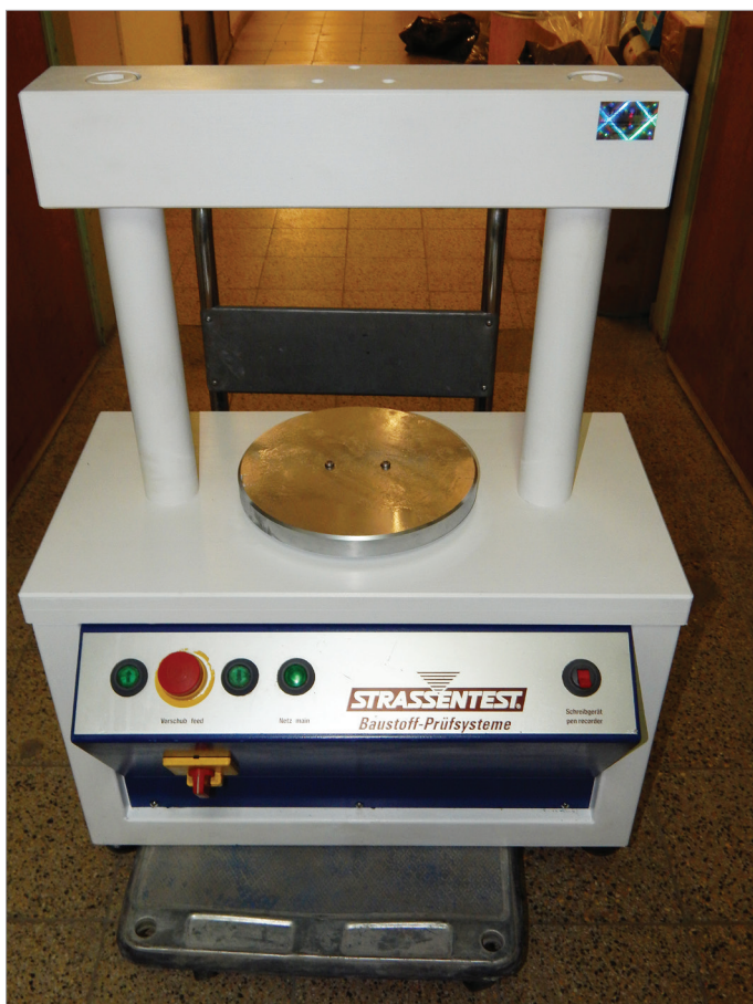
Obr. 14: Kalibrační zatěžovací rám.
