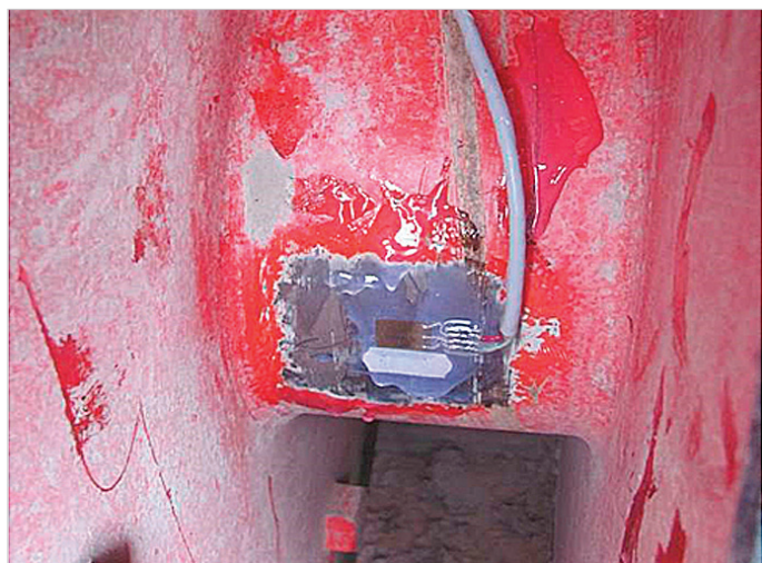
Obr. 6: Pohled na nalepené tenzometry a jejich propojení tenzometrickým kabelem.
