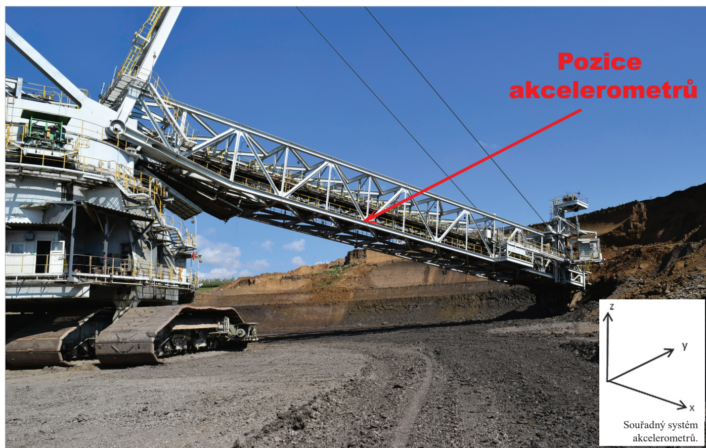
Obr. 2: Snímače na horní pásnici spodního pásu K. V. rýpadla SchRs 1550.
