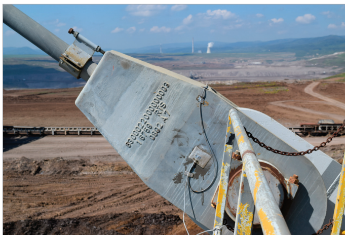
Obr. 5: Tenzometry R1 až R4 na vnější ploše závěsu lana rýpadla SchRs 1550.
