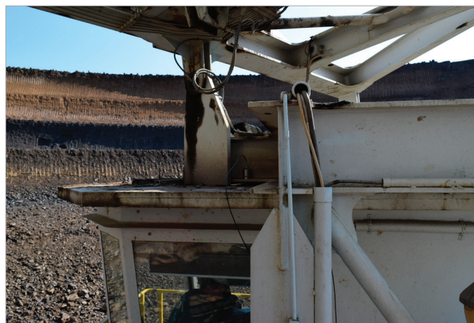
Obr. 6: Umístění akcelometru na závěsu kabiny řidiče rýpadla SchRs 1550.
