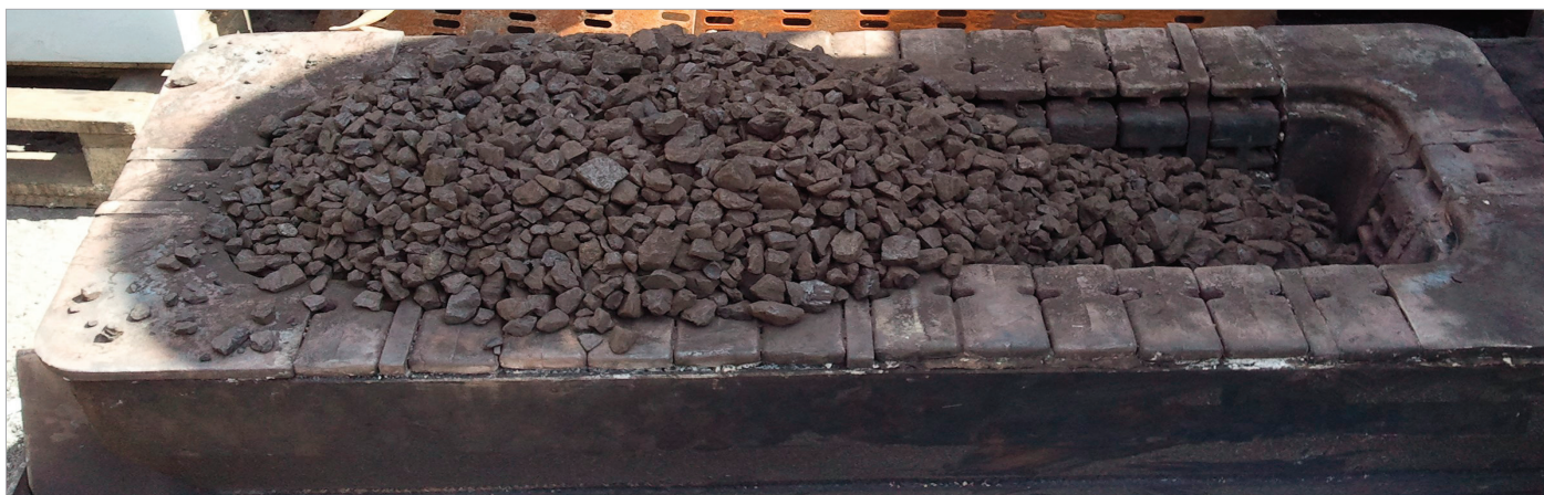
Obr. 3: Neoptimální zaplnění hořáku palivem.
