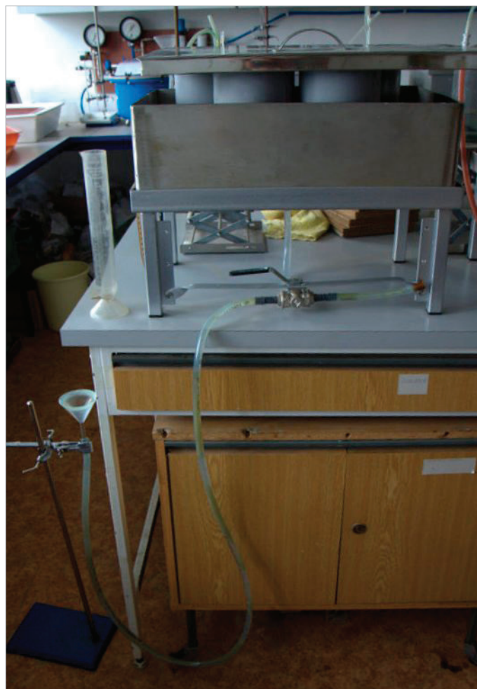
Obr. 4: Odsávání vody při tlakové výšce -5 kPa v pískovém boxu.
