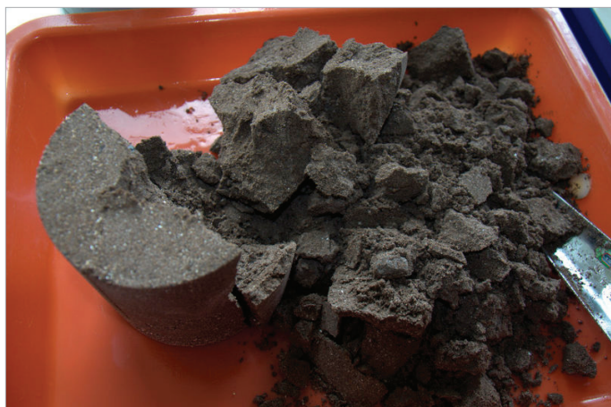
Obr. 5: Vlhký substrát před plněním do testovacích válečků.
