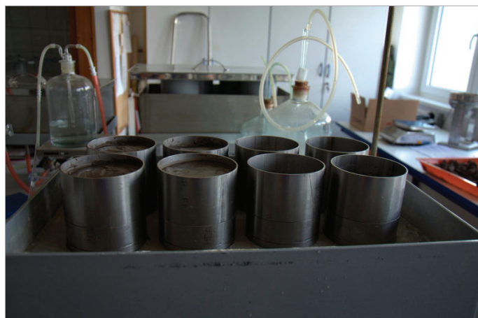
Obr. 6: Sycení testovacích válečků v laboratoři (fáze s prstenci).
