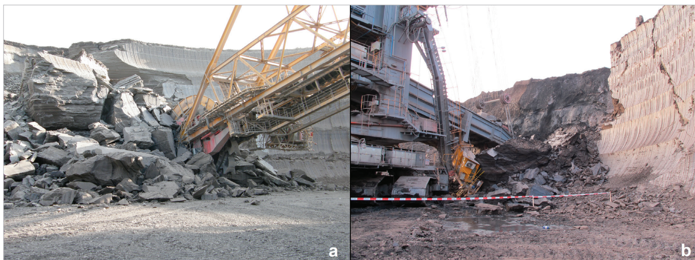
Obr. 1: Příklady velkých havárií způsobených blokovými sesuvy na lomu Bílina.
