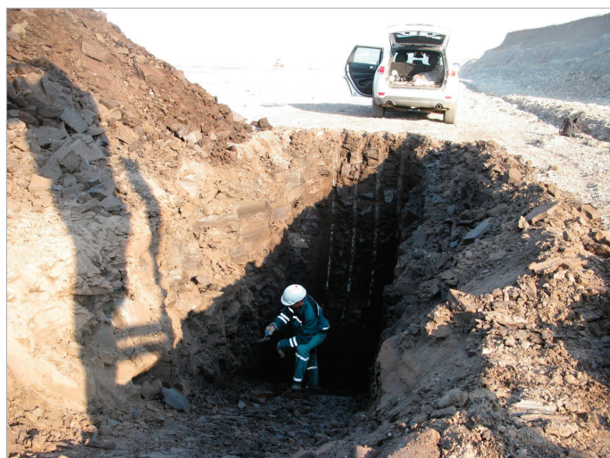
Obr. 1: Dokumentace odběru vzorku z kopané sondy, lokalita DNT, vz. DT-1.
