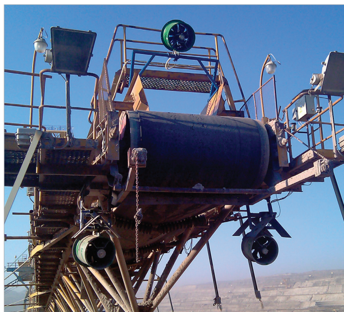
Obr. 9: Rotační atomizéry namontovány na špičce výložníku zakladače.
