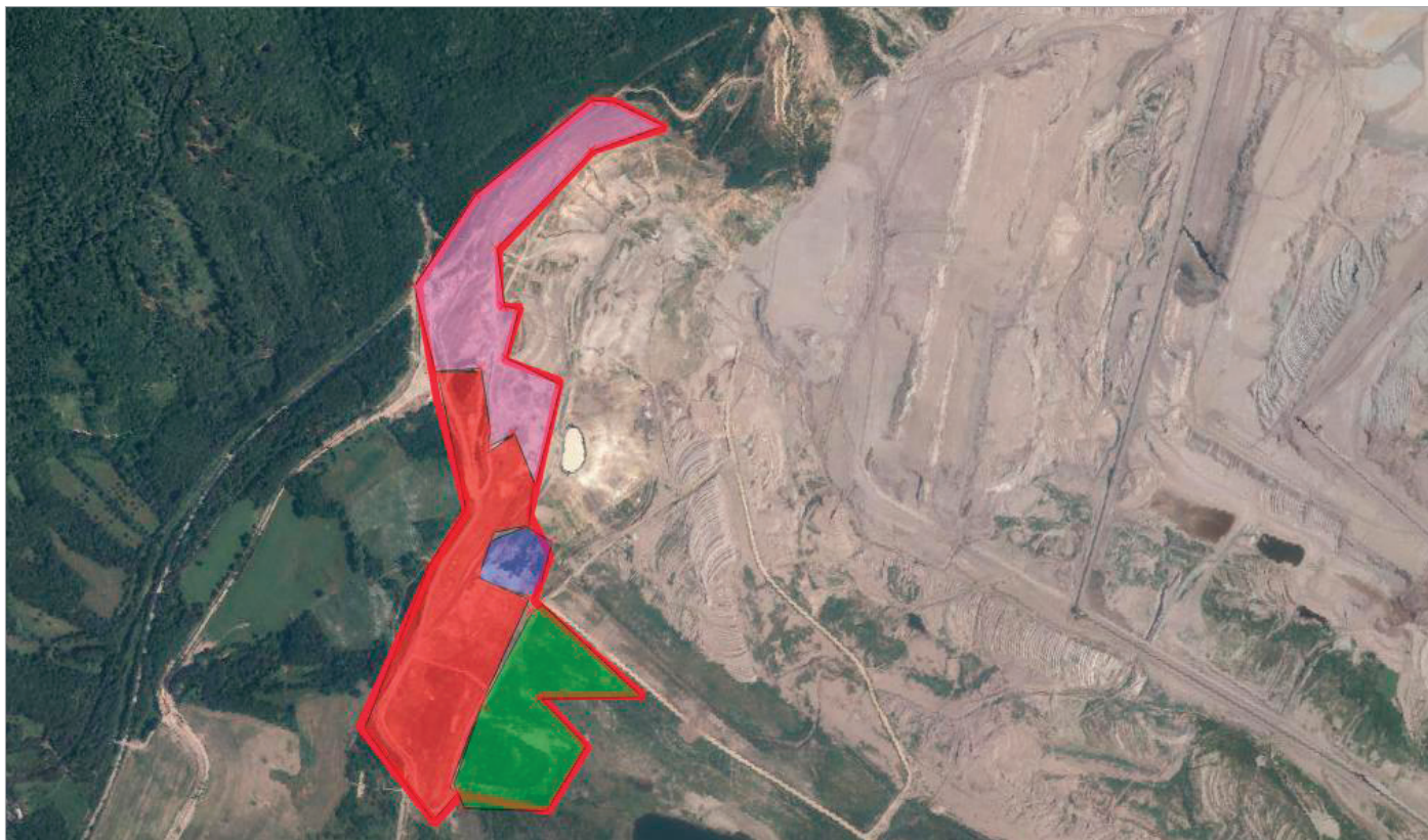
Obr. 2: Povrch zkoumaného území: zelená – jílové deponie se sláným povrchem; červená – rekultivovaný povrch, směs jílu a kamení; modrá – uhelné, fyto toxické výchozy; fialová – převážně exponovaný rulový povrch s mělkým nebo žádným půdním profilem.
