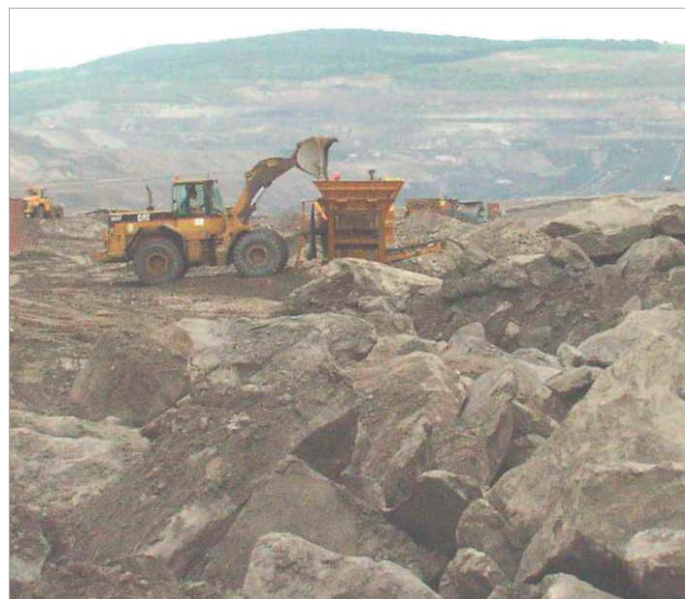
Obr 4: Bloky pískovce s dolomitickým tmelem po nářasné stříbě. (Foto: K. Mach)
