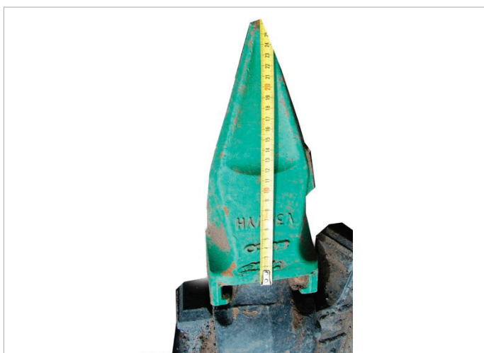
Obr 1a, b, c: Ukázky konstrukce rozpojovacího orgánu – geometrie břitu. (Foto: V. Moni)
