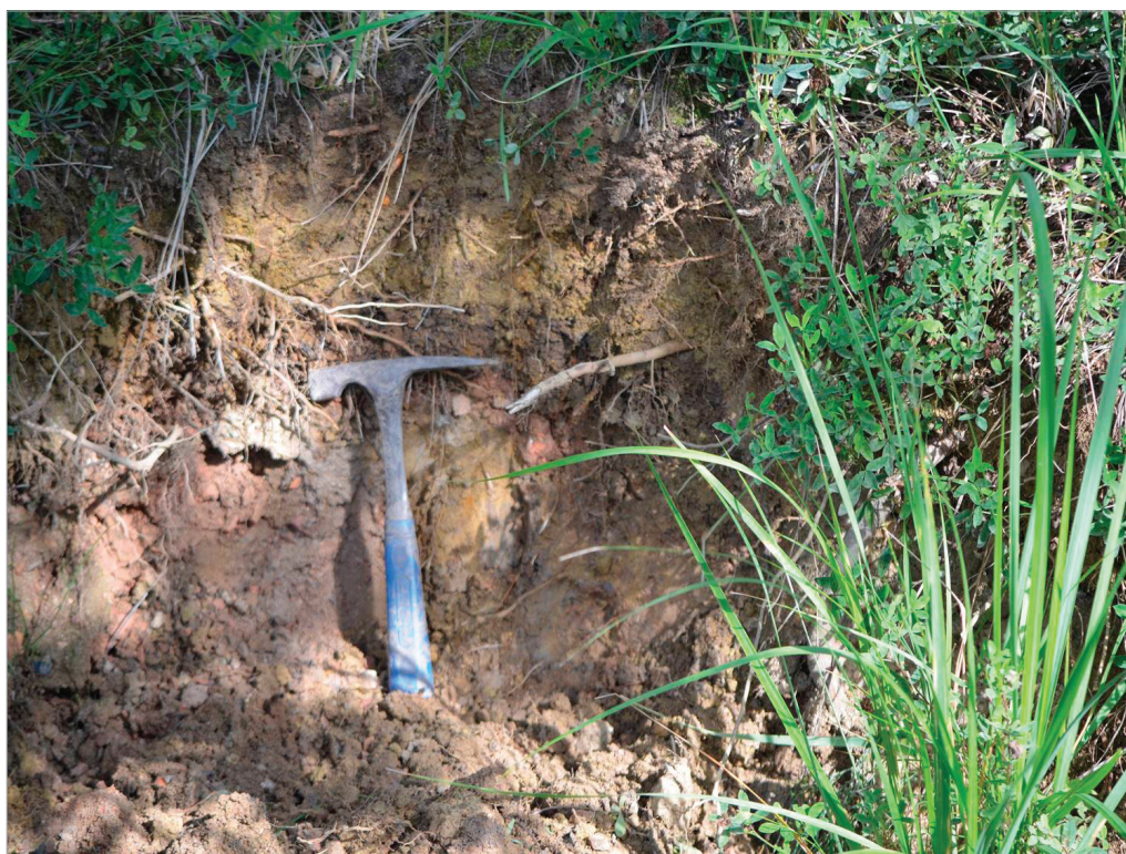
Obr. 1: Antropogenní půdní profil s využitím bentonitu – Střimice, 30 let po aplikaci. (Foto: M. Řehoř)
