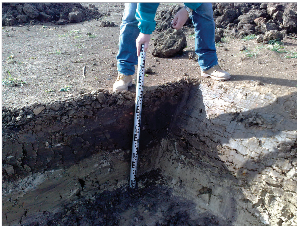
Obr. 2: Antropogenní půdní profil s využitím slínu – Radovesice, měsíc po aplikaci. (Foto: M. Řehoř)
