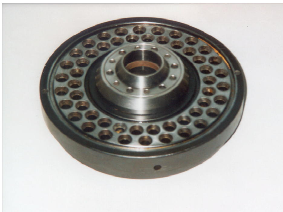
Obr. 3: Raznice laboratorního kolového lisu Presse 14 - 175 f. KAHL.
