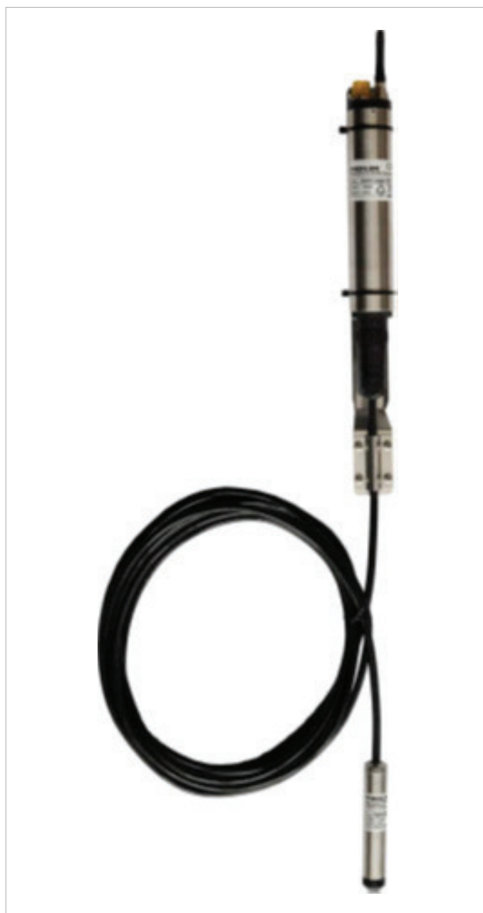
Obr. 3: Měřicí sestava využívaná při kontinuálním monitoringu hladin podzemní vody.
