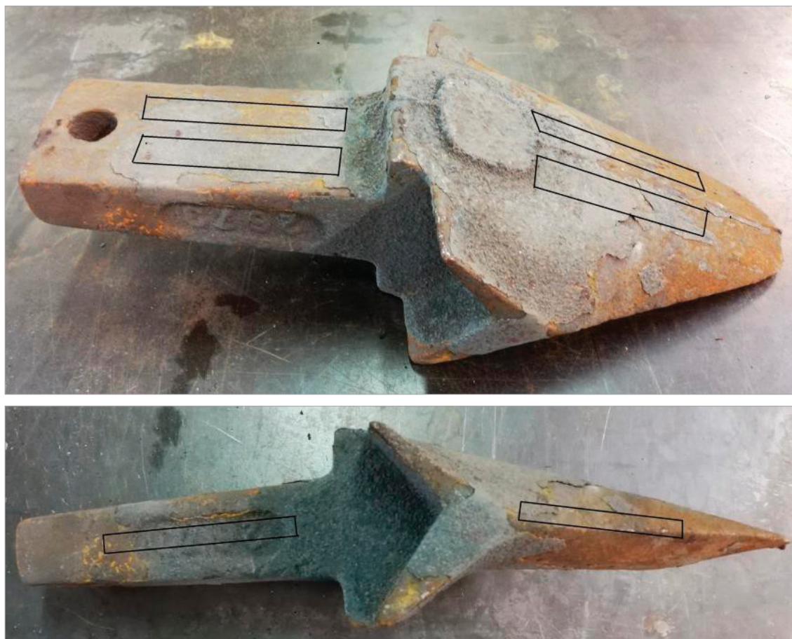
Obr. 2: Místa odběru tahových vzorků.
