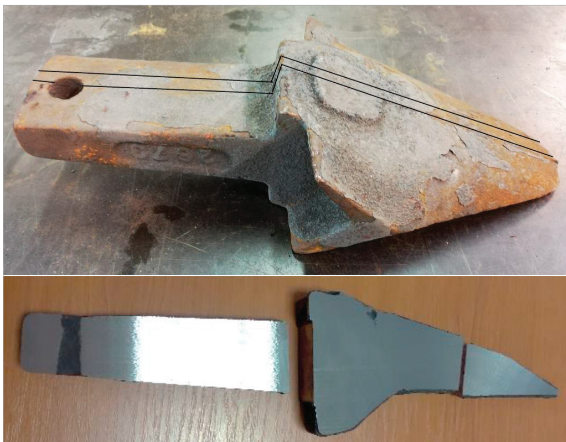
Obr. 3: Naznačení provedeného řezu (nahore), fotografie výřezu (dole).
