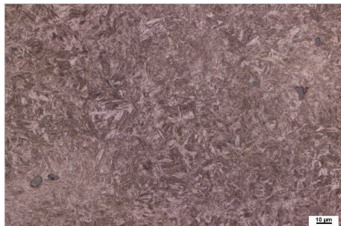
Obr. 19: Metalografický snímek po zušlech-
