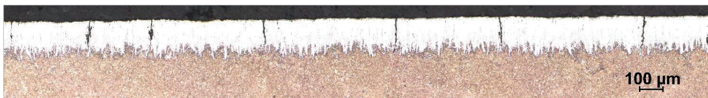
Obr. 21: Metalografický snímek po boridaci – různá zvětšení.
