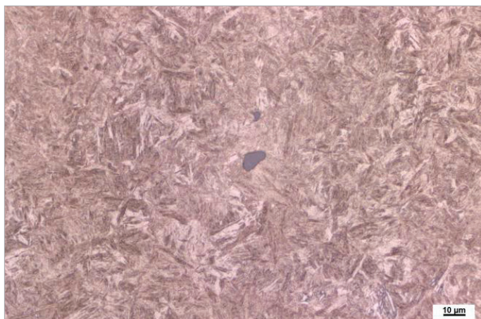
Obr. 20: Metalografický snímek po kryogenním zpracování, režim 3 (vlevo) a režim 4
