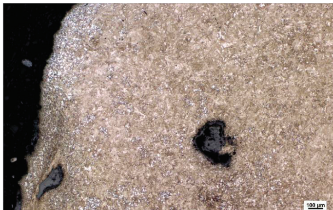
Obr. 6: Špička_1 okraj, mikrostruktura, 50x.
