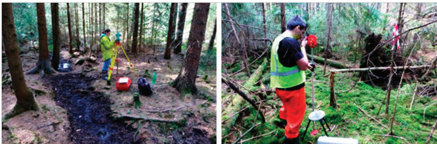
Obr. 4: Geodetické vytyčování a zaměřování souřadnic tíhových bodů v „pralese“ na dně kráteru ZARY. Stativ gravimetru (trojnožka s podstavou vpravo dole) se často bořila hluboko do zvodnělé půdy.
