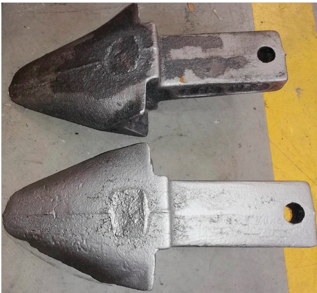
Obr. 1: Tryskané zuby, horní díl: kvalita SA2 (odstranění okují a největších nečistot), dolní díl: kvalita SA3 (zcela čistý a stříbrný povrch).
