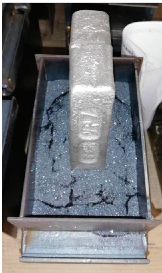
Obr. 9: Uložení zubu v nádobě a uložení vsázky / nádob v šachtové peci.
