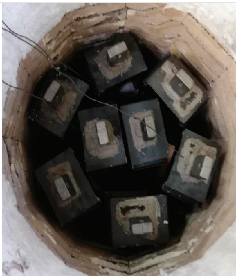
Obr. 9: Uložení zubu v nádobě a uložení vsázky / nádob v šachtové peci.
