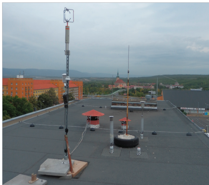
Obr. 3: Stanice pro kontinuální měření PM_{10} a meteorologických veličin VÚHU.
