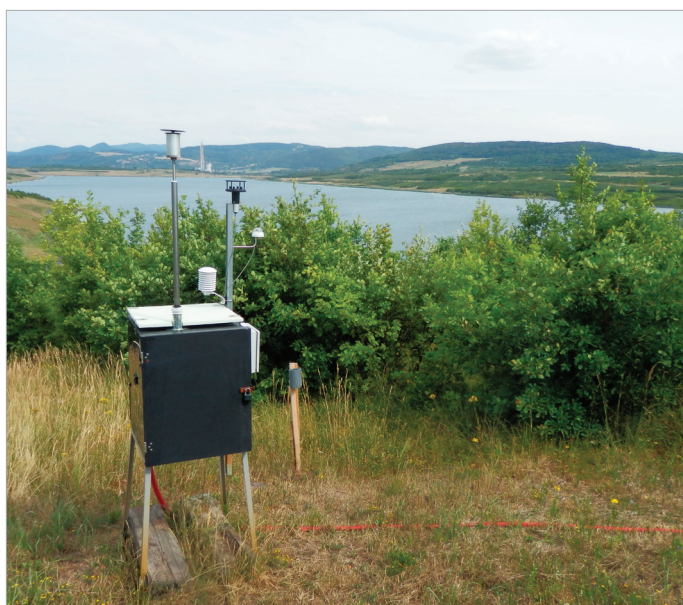
Obr. 7: Stanice pro kontinuální měření PM_{10} a meteorologických veličin na okraji jezera Milada.
