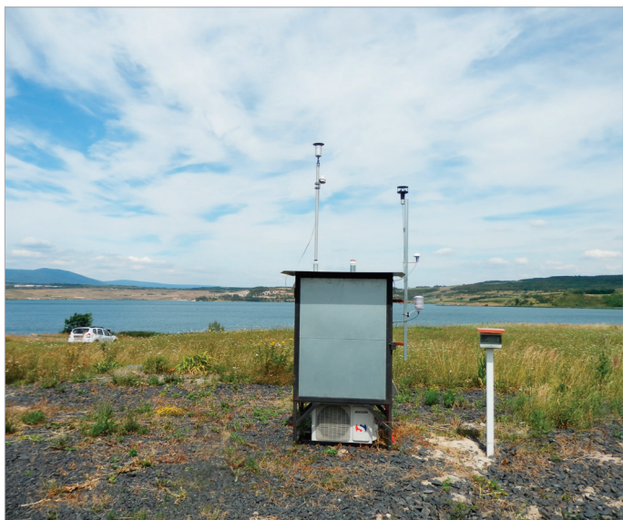
Obr. 4: Stanice pro kontinuální měření PM_{10} a meteorologických veličin na okraji jezera Most.
