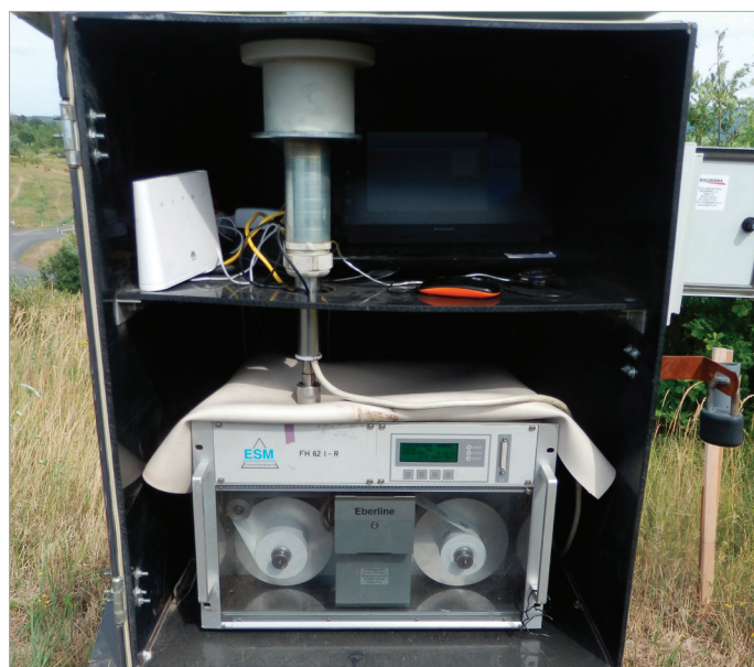
Obr. 7: Stanice pro kontinuální měření PM_{10} a meteorologických veličin na okraji jezera Milada.
