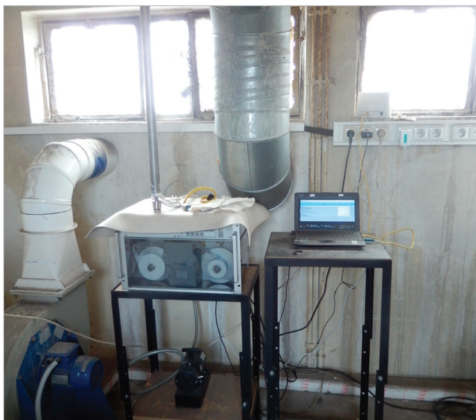
Obr. 3: Stanice pro kontinuální měření PM_{10} a meteorologických veličin VÚHU.
