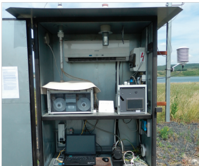
Obr. 4: Stanice pro kontinuální měření PM_{10} a meteorologických veličin na okraji jezera Most.
