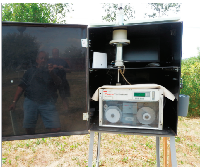
Obr. 5: Stanice pro kontinuální měření PM_{10} v Kopistech.
