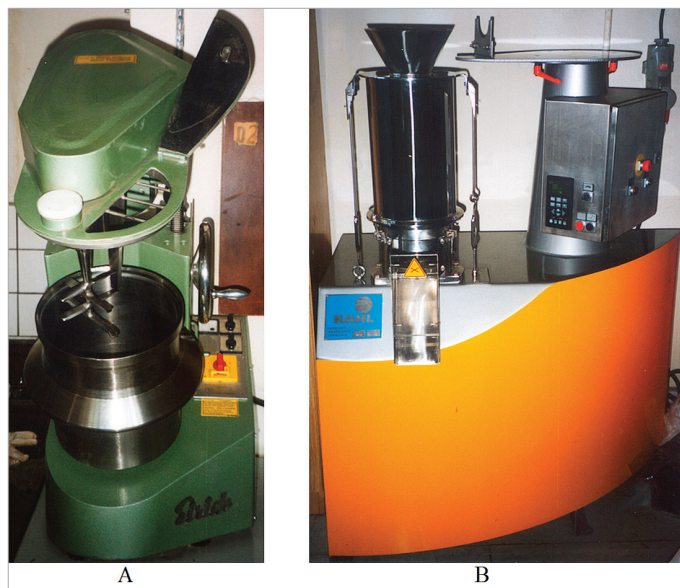
Obr. 1: Zařízení použitá k formování adsorbentu - A (míšič Eirich R-02), B (kolový lis Kahl Presse 14-175).
