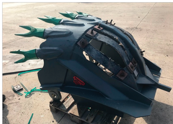
Obr. 3: Nový koreček se zuby ESCO [1].
