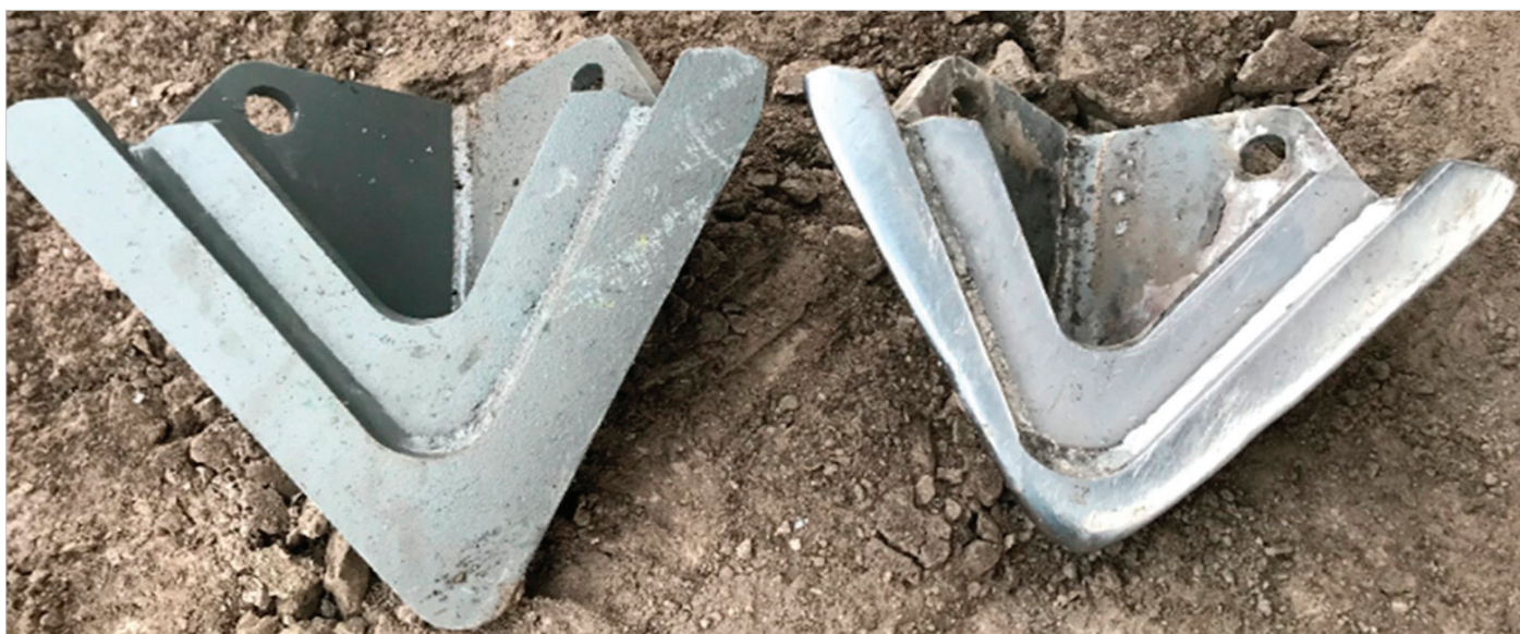
Obr. 10: Porovnání nového a opotřebovaného břitů při jejich výměně.
