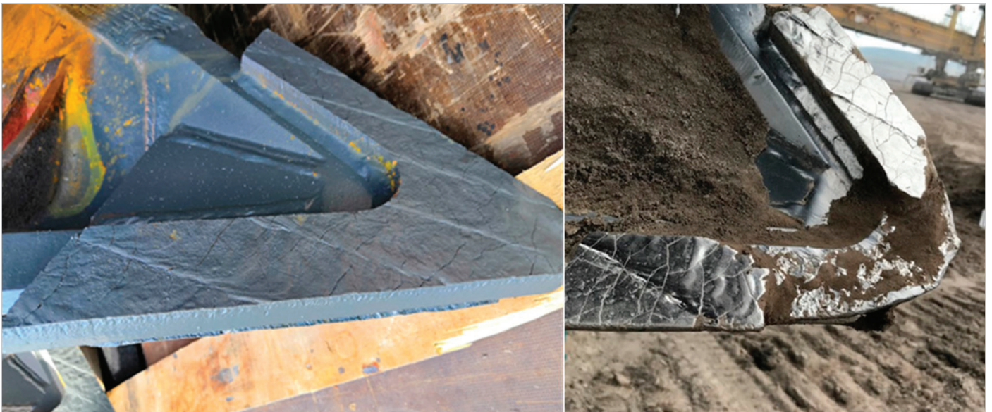
Obr. 4 (zleva): Rohový břit varianta III - nový, rohový břit varianta III - opotřebený.
