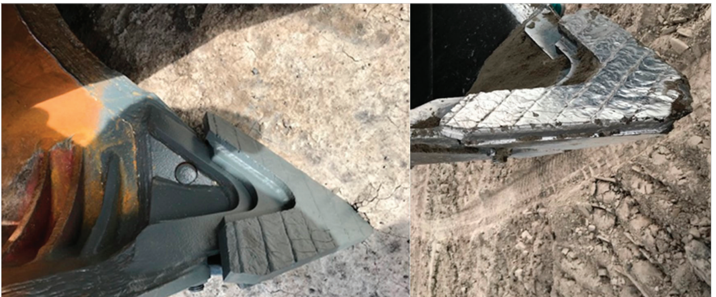
Obr. 5: Rohový břit vyměnný - nový, rohový břit vyměnný - opotřebený.
