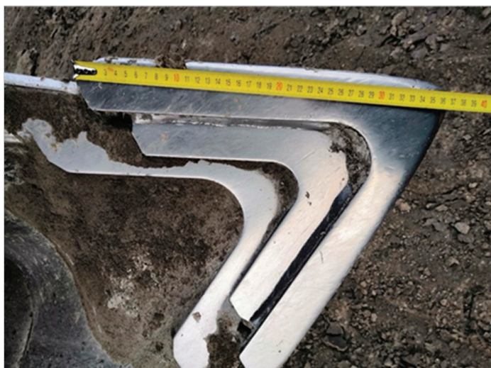
Obr. 9: Měření opotřebení břitů.
