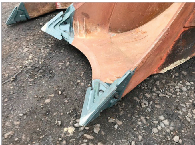
Obr. 8: Břitový koreček osazený upravenými výměnnými břity.
