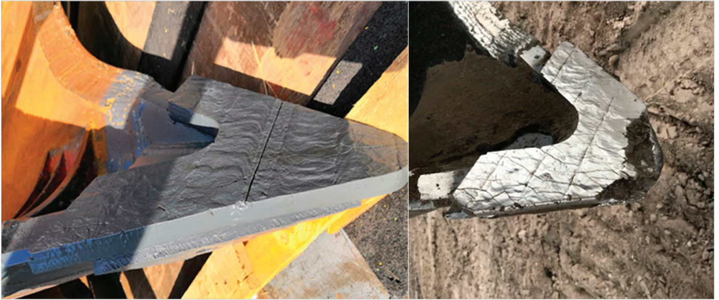
Obr. 3 (zleva): Rohový břit varianta II - nový, rohový břit varianta II - opotřebený.
