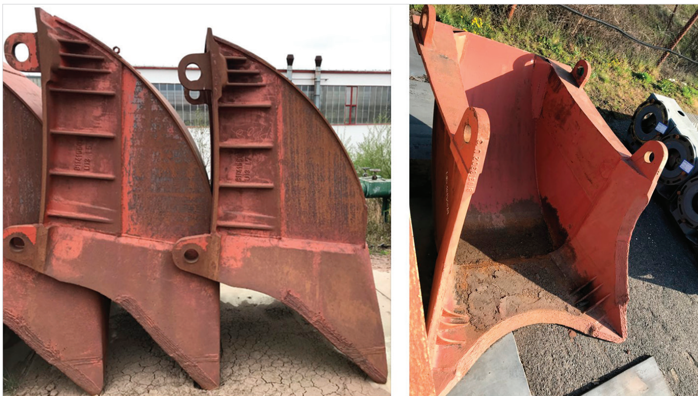
Obr. 1 (zleva): Plný koreček s rohovými břity - boční pohled, čelní pohled.
