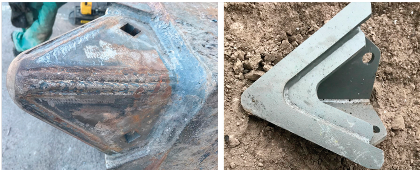
Obr. 6: (zleva): Adaptér pro uchycení výměnného břítu, výměnný břit.
