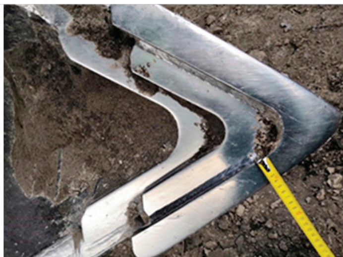
Obr. 9: Měření opotřebení břitů.
