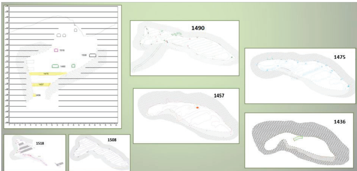
Obr. 18: Schéma jednotlivých pater dolu Sondalo, s vyznačenými dobývacími komorami a dopravními cestami.
