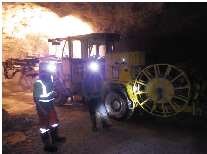
Obr. 5: Lochaline - vrtací vůz Atlas Copco.
