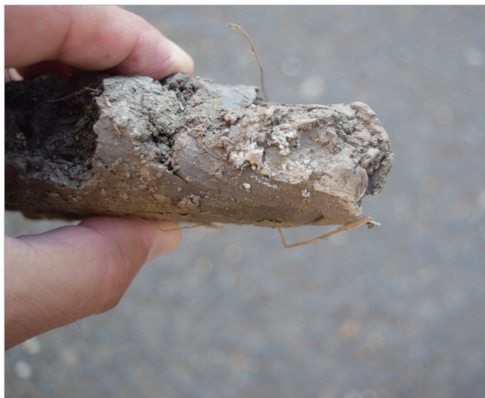
Obr. 5: Výkvěty sádrovce na vzorku jílovce odebraného v roce 2021. (Foto: M. Řehoř)
