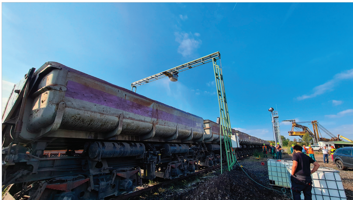
Obr. 2: Aplikace roztoku na povrch VEP v LH voze. (Foto: archiv autora).
