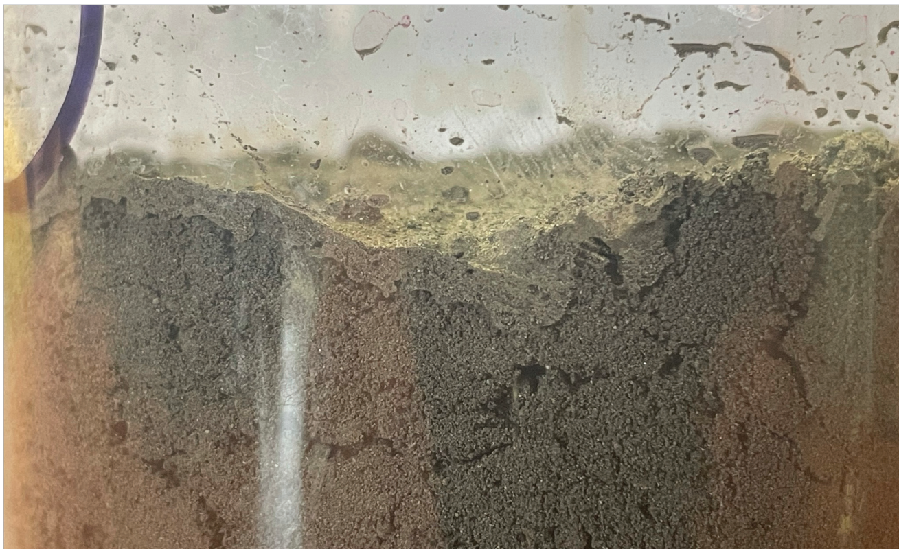
Obr. 5: Detailní pohled na tuhou vrstvu po aplikaci vody. (Foto: archiv autora).
