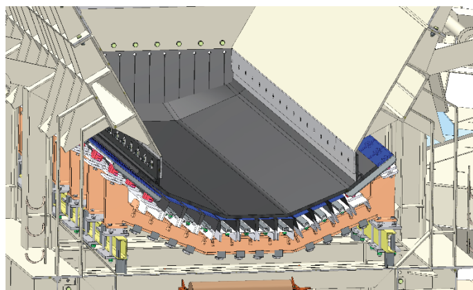
Obr. 3: Dotěsněné dopadové lože (pohled v řezu), dole dopadové lože, dopravní pás a nahoře násypka.
