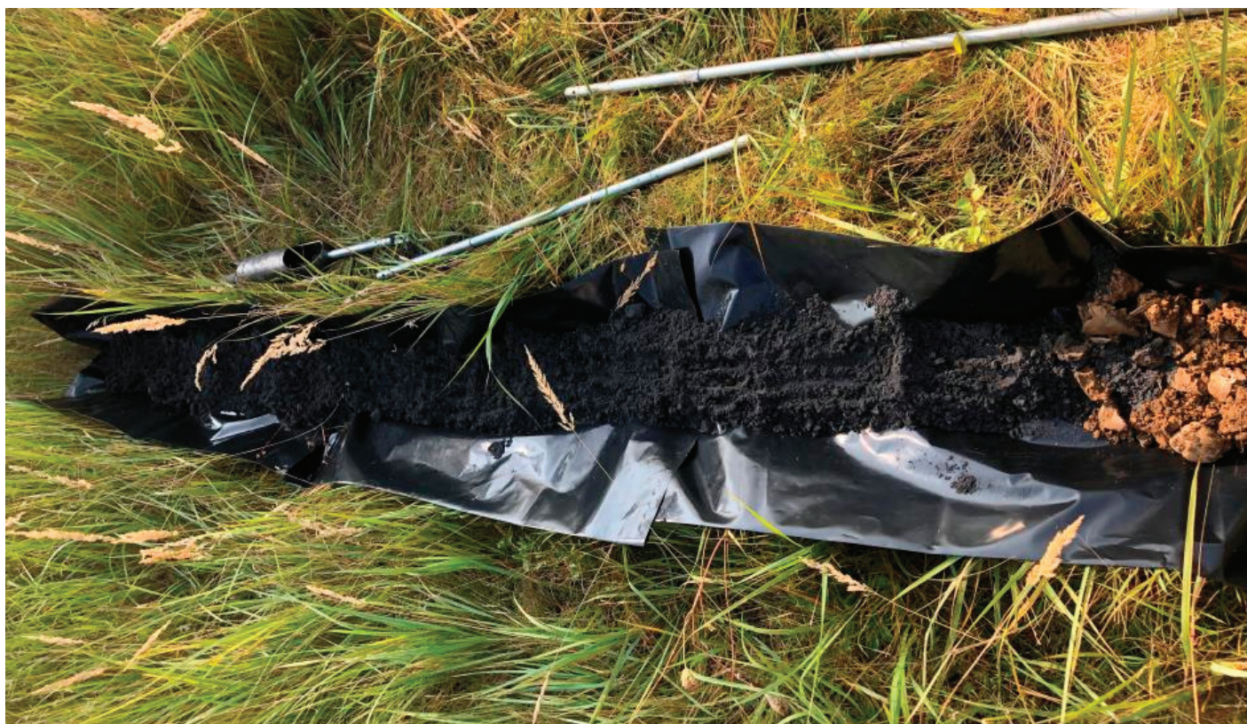
Obr. 1: Ukázka vrtného jádra s patrnou různorodostí materiálu.
