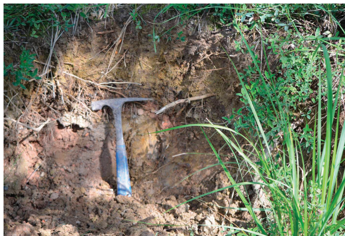
Obr. 2: Pokusná plocha Střimice II - antropogenní půdní profil s využitím bentonitu.
