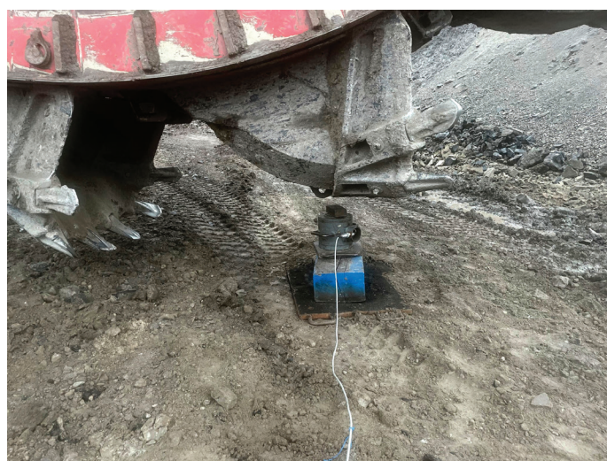
Obr. 15: Příprava při měření odlehčení KV KU 300.
