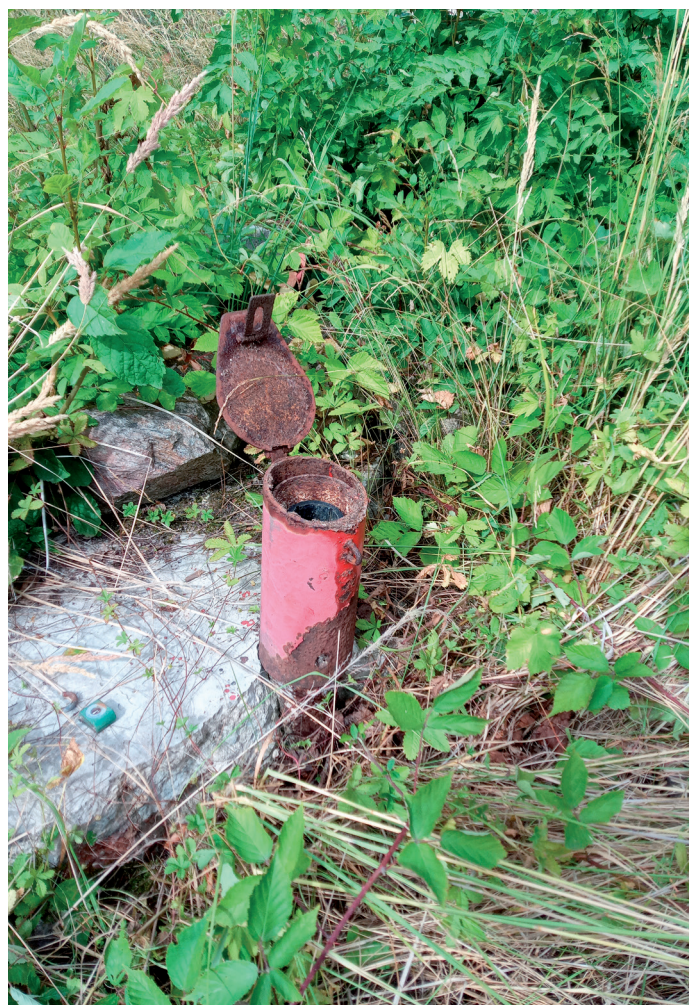
Obr. 3: Fyzický stav vrtů inženýrsko-geologického průzkumu.
