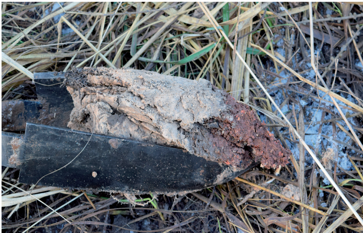
Obr 4: Půdní sonda s obsahem energósádovce. (Foto: M. Řehoř).
